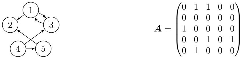
Figura 1.2: A destra la matrice di adiacenza costruita a partire dal grafo di sinistra.
