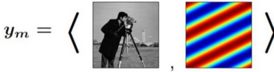
Figura 3.1: Esempio di registrazione di valori, utilizzando come forma d'onda \varphi una senoide
