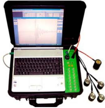
I dati di partenza utilizzati nel presente studio sono del tipo mostrato in figura, in cui sono riportate le misure in ingresso ed in uscita, e di cui lo strumento restituisce direttamente i tempi di ritardo che sono utilizzati per l'impostazione del sistema tomografico.
