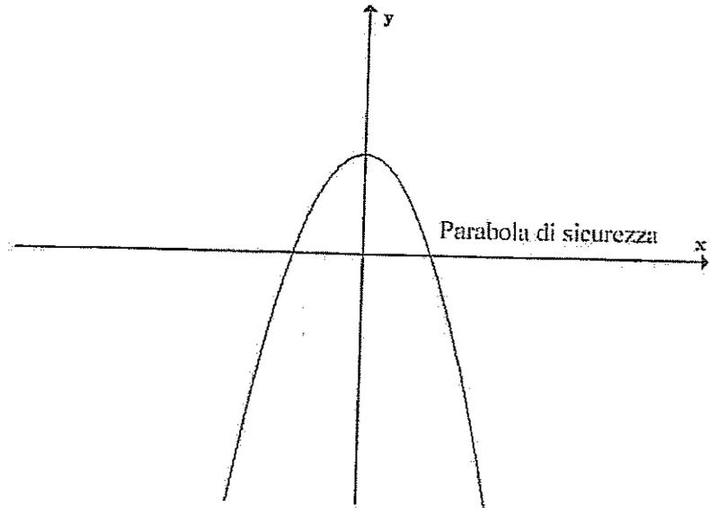
I punti interna ad essa vengono raggiunti con due diversi possibili angoli, i punti su di essa vengono raggiunti con un solo angolo di inclinazione, quelli esterni non possono essere raggiunti.
